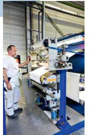
Auf dieser Laboranlage wurden Mitte der 90er Jahre die ersten 2 Mio. m 2 Oberflächen für Fußböden produziert. Heute dient sie für die Farbausmusterung
