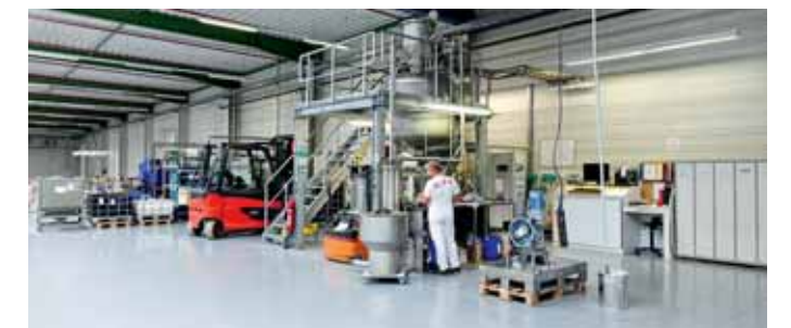
Sämtliche von DTS eingesetzten Lacke sind Eigenentwicklungen, die aus Standardkomponenten der Chemischen Industrie grundsätzlich im eigenen Haus angemischt werden
